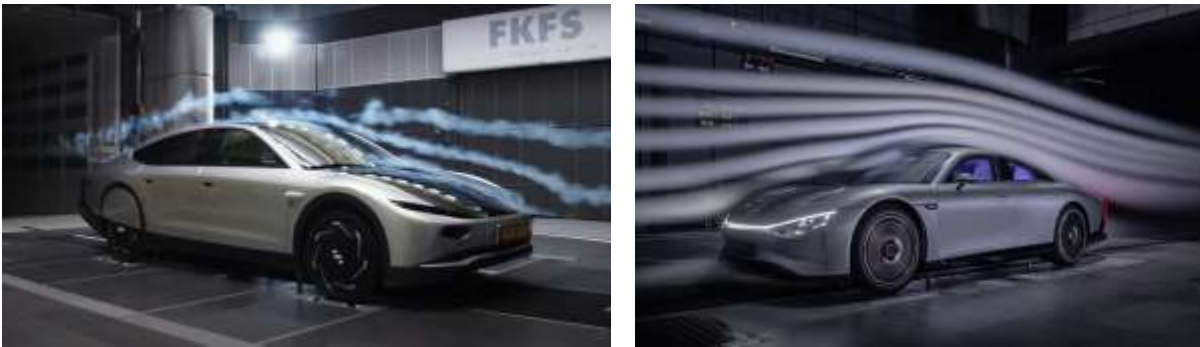
Figuur 5: Links de Lightyear 0 in de windtunnel (AUTOUA, 2022), met een C_d van 0,175 en rechts de Mercedes-Benz Vision EQXX (ArenaEV, 2022), met een C_d van slechts 0,17 een grote verbetering ten opzichte van bijvoorbeeld de VW Passat (0,25) (Hyde, E., 2024).
